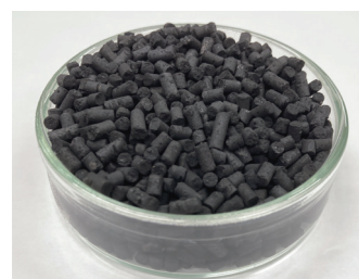
▲図3：新規CO 2 吸収材「Na-Fe系酸化物」
